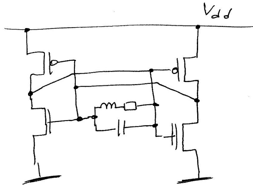
Dans ce cas, la transconductance du circuit vaut  $g_{mp} + g_{mn}$ , et donc la résistance négative vaut  $-\frac{1}{g_{mp} + g_{mn}}$ .
