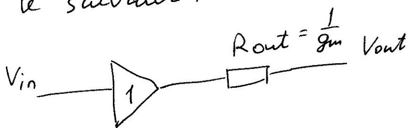
Ce schéma est équivalent à une transconductance (Northon - Thévenin pour la source de sortie)
