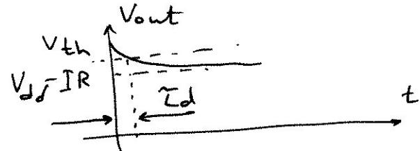
La source  $i_n(t)$  retire instantanément une charge  $\Delta q$  à l'instant  $\tilde{t}$  de la capacité! Ainsi, si  $0 < \tilde{t} < \tilde{t}_{\text{nominal}}$ , le délai de la cellule est plus petit:
